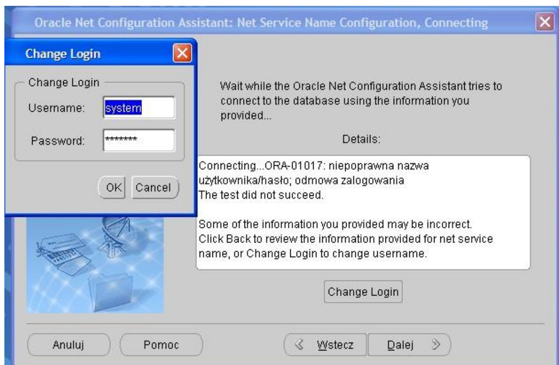
C.9 Typowym problemem podczas testu dobrze skonfigurowanego połączenia jest niewłaściwe hasło użytkownika SYSTEM bazy danych, które należy zmienić i ponownie test połączenia
